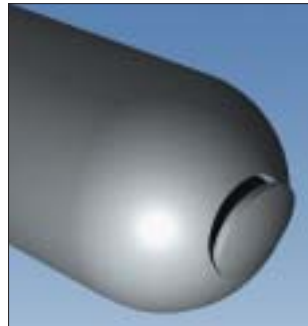
Abb. 12 Der C-förmige Ausschnitt zeigt, daß die Blase unter dem Ventilteller des Bodenventils eingeschlossen wurde
