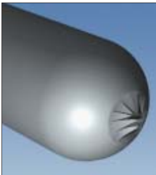
Abb. 11 Sternförmige Risse werden durch einen Verlust der Blasenelastizität verursacht
