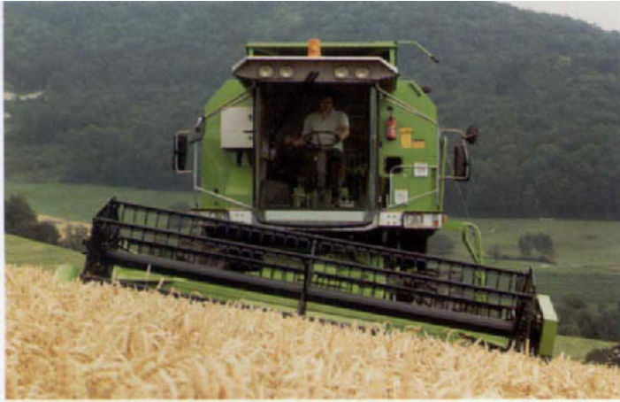
HCS-Hill Control System zum Hangausgleich bei Mähmaschinen HCS-Hill Control System for slope compensation on combine harvesters. HCS-Hill Control-System pour la régulation d'horizontalité des moissonneuses-batteuses.
